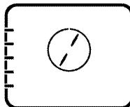
Varmluft, som värms av det bakre elementet, fördelas snabbt och jämnt i ugnen tack vare fläkten.
