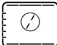
Övervärme, undervärme och fläktassisterad värme används. Maten tillagas jämnt och snabbt. Tillaga maten med endast en långpanna.
