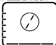
Undervärme och fläktassisterad värme används. Lämpligt för att baka pizza.
