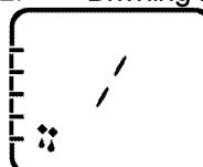
Ugnen värmes inte upp. Endast fläkten (i bakre väggen) används. Passar för att långsamt tina upp mat i rumstemperatur samt att kyla ner varm mat. Tiningstiden är längre för en hel stek än för mat med ådror.
